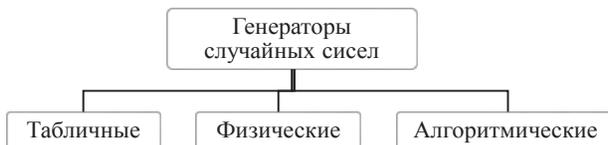
Рис. 1. Классификация генераторов случайных чисел
