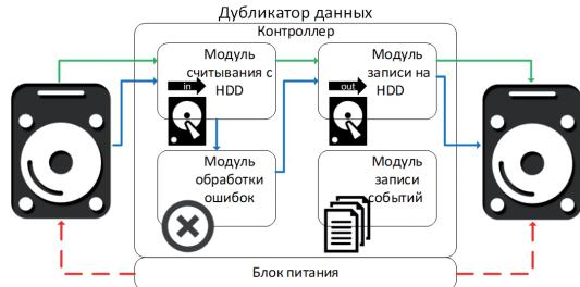
Рис. 3. Принципиальная схема дубликатора
