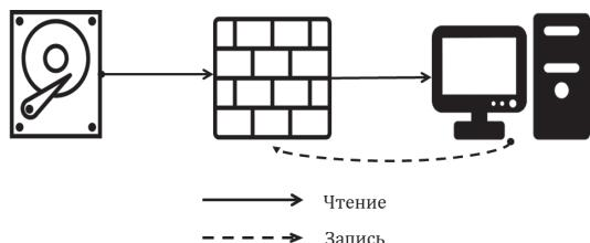
Рис. 1. Общая схема работы блокиратора записи
