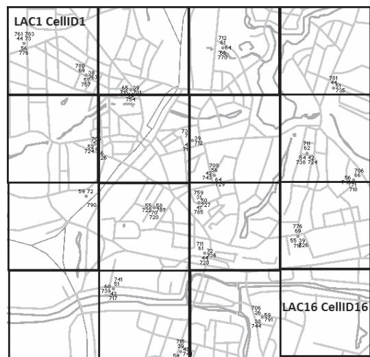
Рис. 2. Схема разделения моделируемой территории на области действия базовых станций
