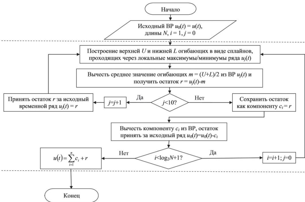
Рис. 1. Блок-схема алгоритма эмпирической модовой декомпозиции (ЭМД)
