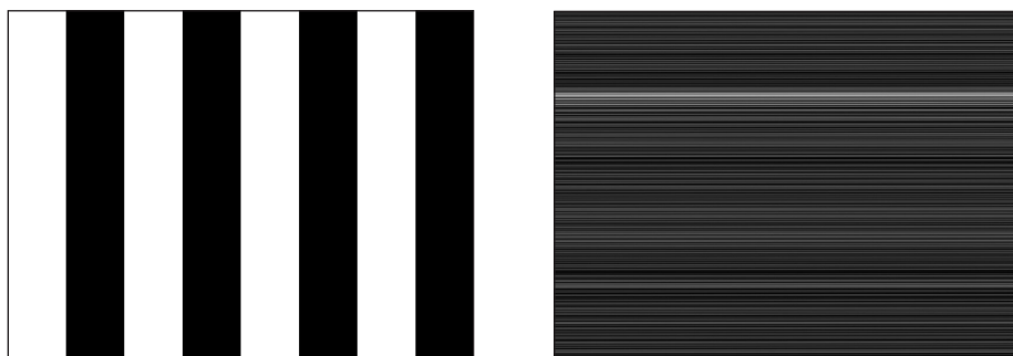
Рис. 3. Пример тестового сигнала (слева) и соответствующее ему перехваченное изображение (справа).
