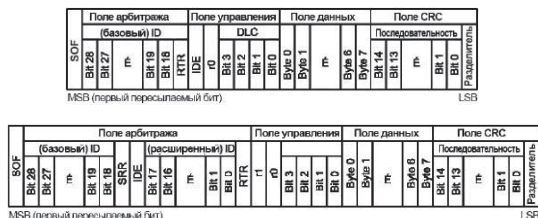
Рис. 1. Порядок передачи битов (сверху – базовый формат 2.0A, снизу – расширенный 2.0B)
