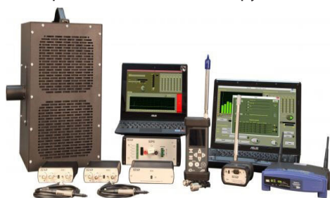
Рис. 8. Программно-аппаратный комплекс для проверки выполнения норм эффективности защиты речевой информации от её утечки по акустическому и виброакустическому каналам «Спрут 7-М»
