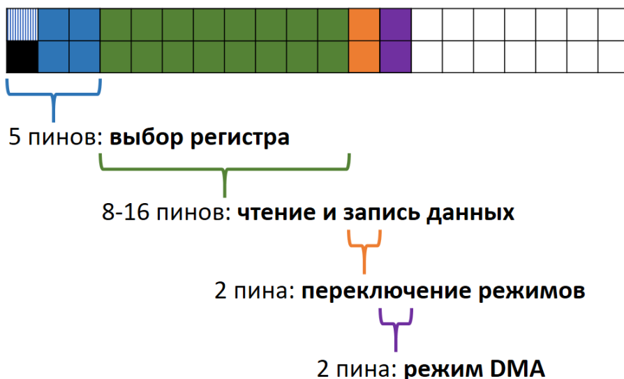
Рис 2. Требуемые пины для взаимодействия с интерфейсом IDE AT
