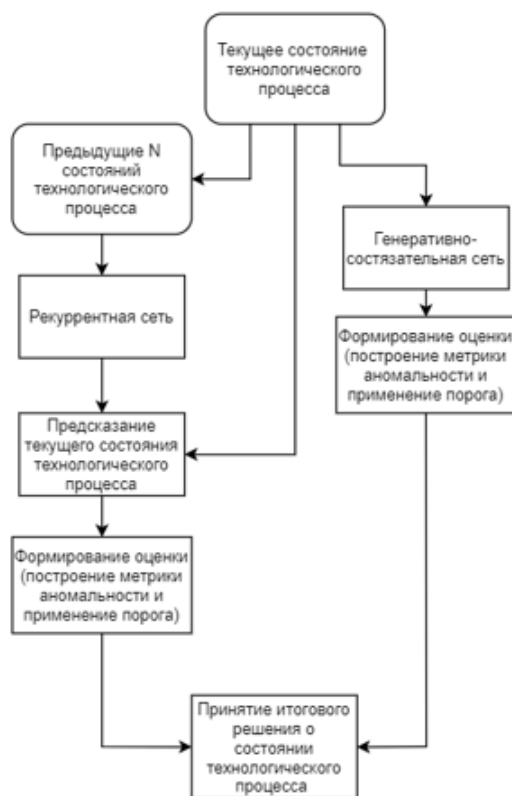
Рис. 5. Схема ансамблирования моделей нейронных сетей для обнаружения вторжений в АСУ ТП
